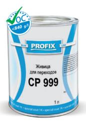
Живица для переходов **СР 999** используется при ремонте лакокрасочного покрытия для сглаживания цвета приготовленной эмали с существующим цветом автомобиля. Применяется с компонентами **СР 99 PREMIUM**. Предварительно нанести живицу на ремонтируемый элемент. Затем методом "мокрое по мокрому" нанести приготовленную для ремонта эмаль. Благодаря специальным свойствам смолы на стыке возникшего перехода не образуются "яблоки", а различие оттенков не невозможно заметить.
